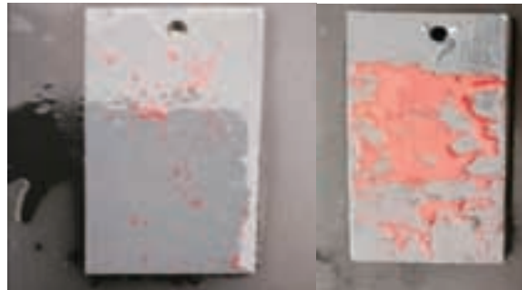
图5 为本研究I型（左）与市售I型（右）清洗剂的摆洗后试片的形貌
