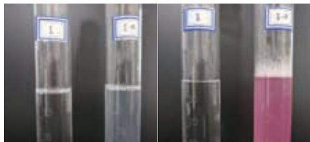
图2 本研究I型和II型清洗剂与市售I型和II型清洗剂水溶性对照
