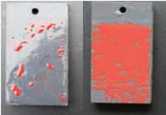
图 6 本研究型（左）与市售 II（右）型清洗剂的摆洗后试片的形貌
